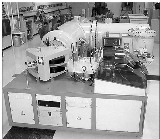
L'accélérateur Tandem du Laboratoire de faisceaux d'ions de l'Université de Montréal; cet appareil peut créer une tension de 1,7 mégavolt.
